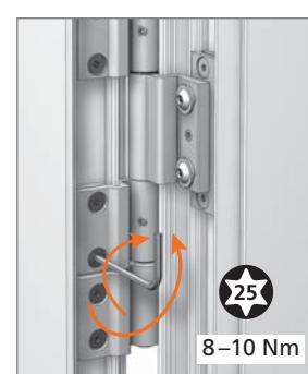
Atornillar de nuevo los tornillos de fijación de **todas** las bisagras y retirar la herramienta de regulación vertical.
