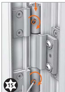
Fijar bulón de apoyo en cuerpo inferior, deslizar cuerpo superior, fijar bulón de apoyo en cuerpo superior.
