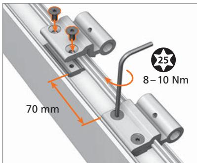
Atornillar bisagra inferior, solo fijar ligeramente bisagra superior.
