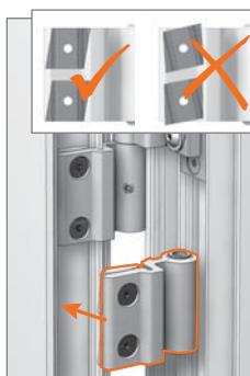
Introducir herramienta de regulación vertical en el perfil del marco, justo por debajo de la bisagra inferior.
