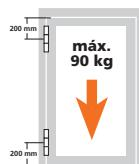
Carga máxima depende de los detalles de los perfiles. Carico in funzione dei profili impiegati. Carga a depender dos perfis utilizados.
