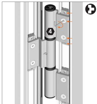
Fijar todos los tornillos del elemento de marco superior.
