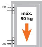
Carga máxima depende de los detalles de los perfiles. Carico in funzione dei profili impiegati. Carga a depender dos perfis utilizados.
