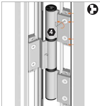
Aflojar todos los tornillos del elemento de marco superior.
