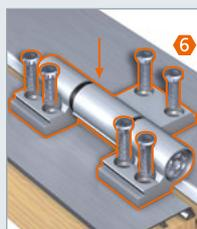
Fissare la cerniera avvitando le apposite viti a fondo nella filettatura delle viti di ancoraggio (forza di serraggio 20 – 25 Nm).
